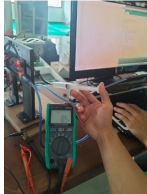
Figure9. Testing MPX10DP Sensor
