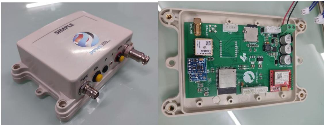
**Gambar 11.** Perangkat keras data logger dengan sistem *internet of things*
