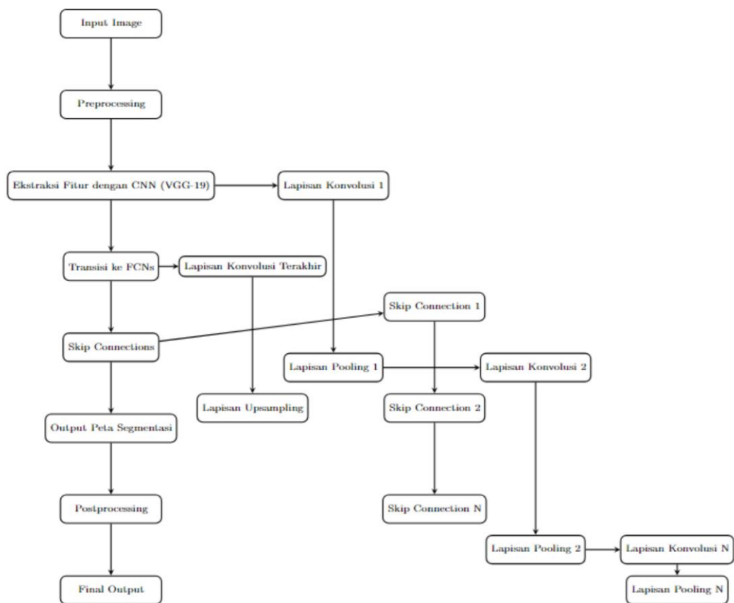
Gambar 3. Flowchat Kerangka VGG-19 berbasis CNN kombisani FCNs
