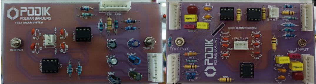
Gambar 6. Tampilan PCB Plant Sistem Orde 1 dan 2
