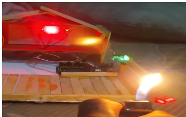
Gambar 8. Pengujian Sensor Flame Terhadap Objek Api
