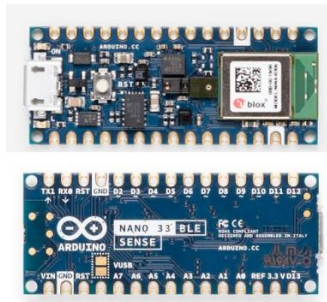
Figure 1. Arduino Nano 33 BLE Sense
